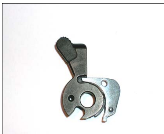
Uña de retenida alojada en la hendidura del martillo permitiendo la percusión
